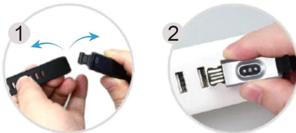
Inserire la spina di ricarica del tracker nella porta USB per la ricarica. Assicurarsi che i pin della spina di ricarica siano in contatto con quelli della porta USB.
